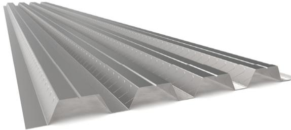
El perfil **ING60.SD** para **forjado colaborante** se fabrica en chapa de acero galvanizado con dos espesores nominales: 0,8 y 1,00 mm, siendo un perfil de **alta resistencia** gracias a su simetría, proporciona ventajosas **prestaciones técnicas y económicas** frente a los sistemas convencionales de forjado.
